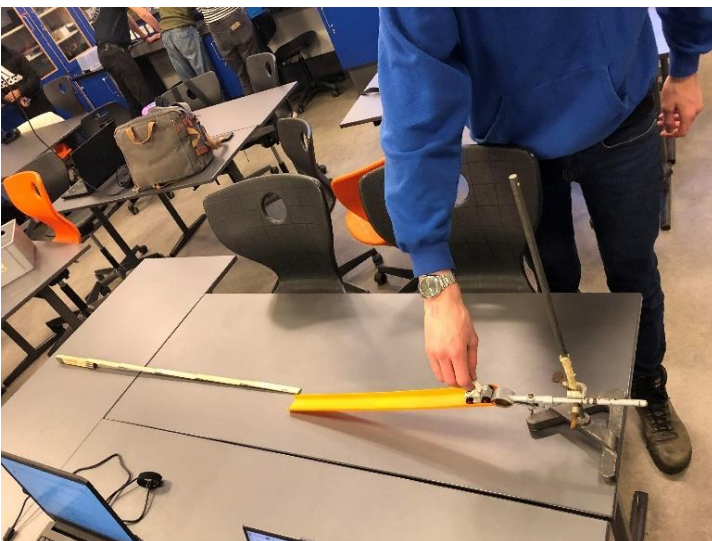
Figur 3: Forsøgsopstilling til rampen, h=0,11 \text{ m} og rampen, s_1=0,52 \text{ m}
